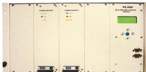
Максимальный отдаваемый в нагрузку ток при двух БПС – 40 А, при трёх БПС – 60 А.
