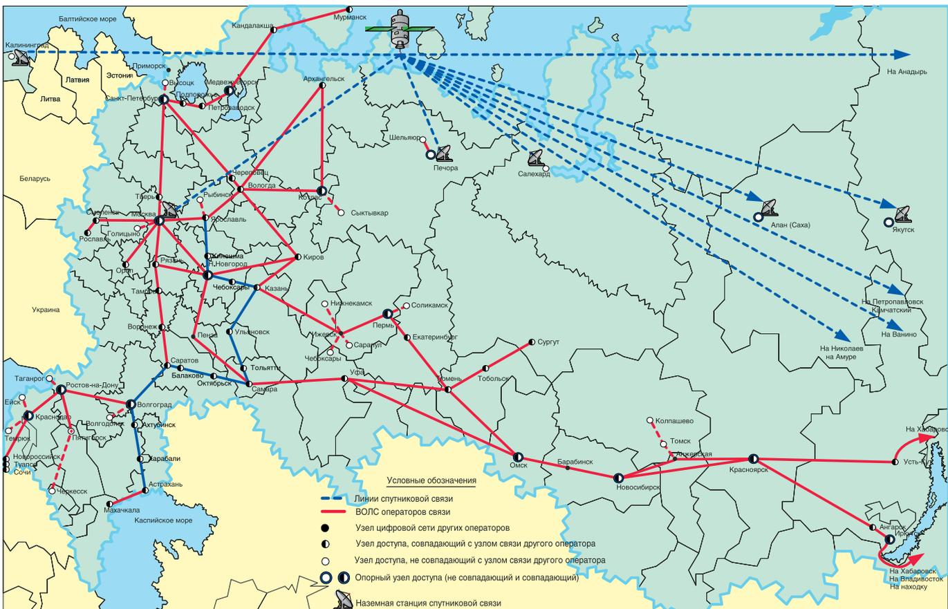
Рис. 1. Схема сети связи «Росморречфлота» на базе цифровых линий и спутниковых станций операторов связи
